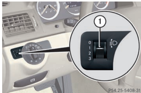
① Pokrętko do regulacji zasięgu świateł
